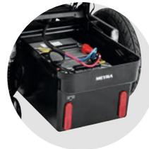
Einfach Batteriewartung durch ausziehbaren Batteriekasten
